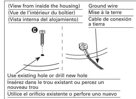
**Riesgo de incendio o descarga eléctrica: Tenga cuidado cuando taladre orificios, puede dañar el cableado y las piezas eléctricas de la luminaria.**
